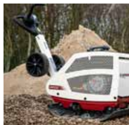
Szerokie kółka odporne na przebiecie ułatwiają transport
