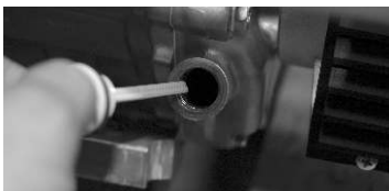
Fot. 1 Sprawdzenie poziomu oleju w silniku jednocylindrowym Honda, Mitsubishi, Rato
