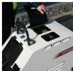
Łatwo otwierane osłony dają dostęp do punktów codziennej kontroli
